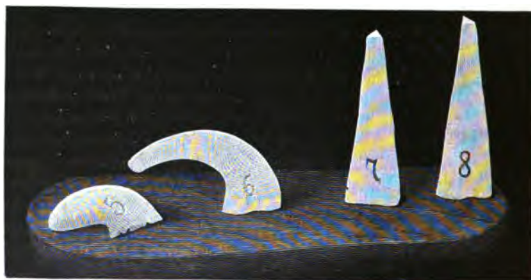
Fig. 70. — Aspect des cônes de Seger fondus.
